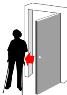
Figura 4.16: Riesgo de impacto en el movimiento de cierre
